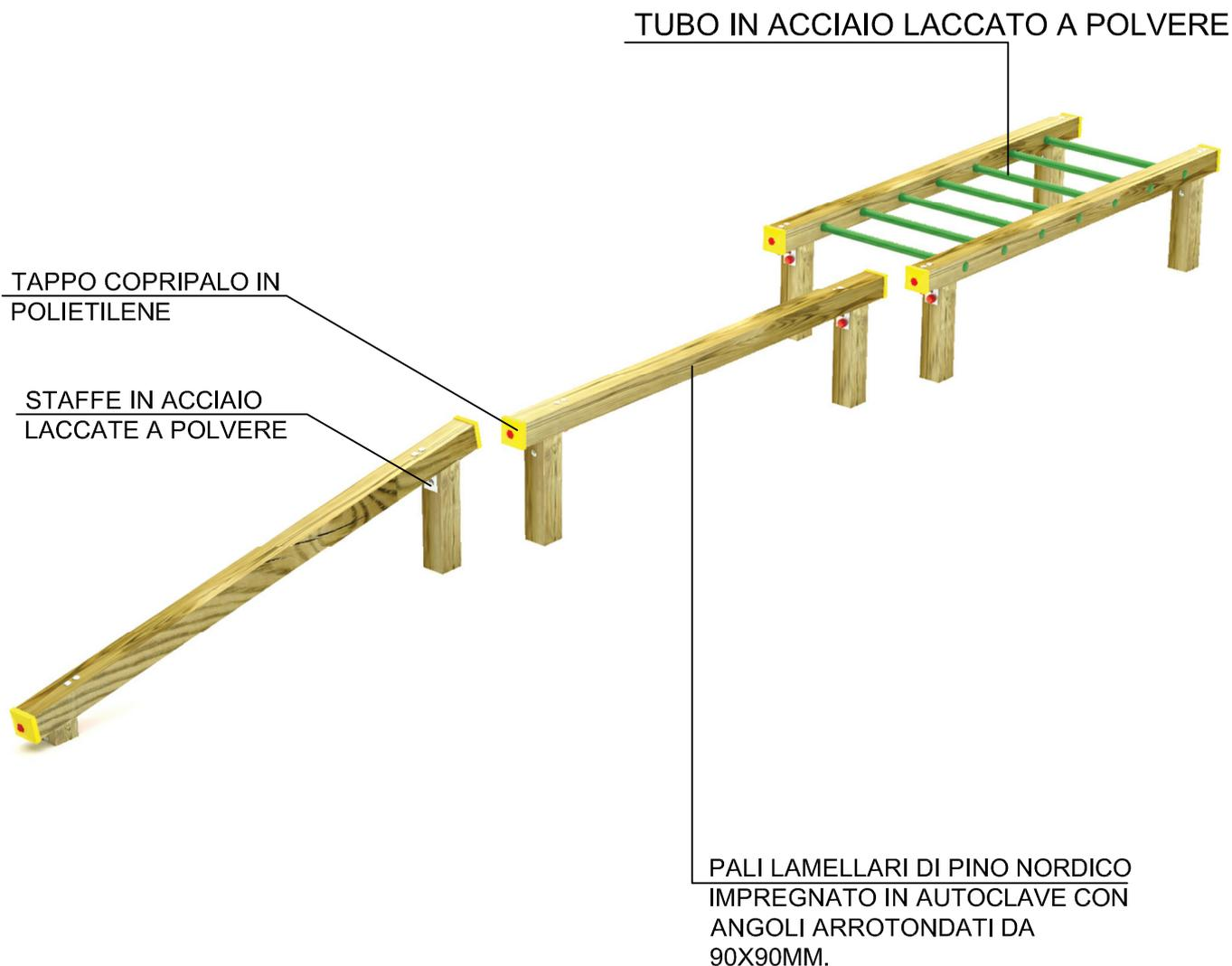
TUTTI GLI ELEMENTI DI FISSAGGIO, VITI, DADI, RONDELLE ECC. SONO IN ACCIAIO ZINCATO E PROTETTI DA GHIERE E TAPPI IN POLIETILENE
